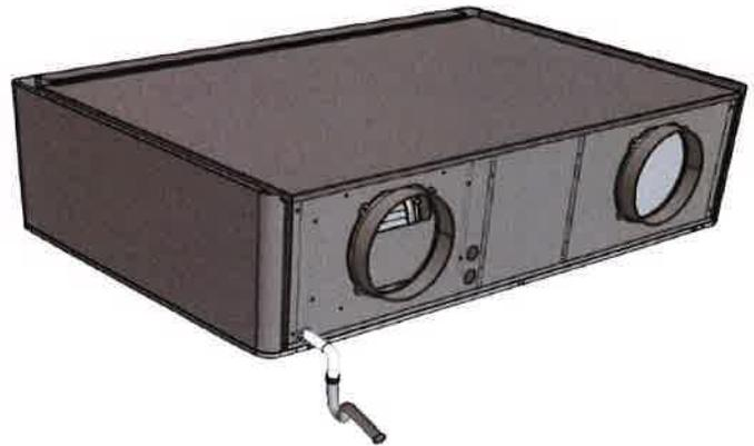
Nel caso di impossibilità di portare all'esterno lo scarico condensa, è possibile uscire sulla parte laterale dx dell'unità utilizzando il foro pretranciato sulla parte laterale;
