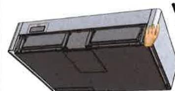
Fissare l'unità al soffitto, tramite le staffe, utilizzando idonei sistemi di ancoraggio (tasselli, , catene...) e verificarne il livellamento aiutandosi con una livella.
