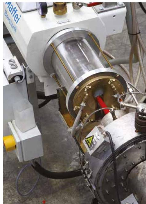
La produzione è realizzata negli stabilimenti Giacomini per mezzo di estrusori di ultima generazione che, partendo dal polimero di base in pellet, realizzano in linea la tubazione fino all'avvolgimento in bobine. Nelle figure qui presenti sono rappresentate alcune fasi del processo produttivo di estrusione.
