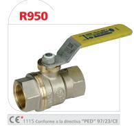
Válvula con esfera DADO®, niquelada, hembra y palanca. Paso integral. Serie robusta Certificada según la Norma europea EN 331:1998 de DVGW, CERTIgaz y ADVANTICA
