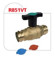
Válvula de esfera no cromada, conexiones de compresión con junta tórica negra según la norma EN681-1 para instalaciones de distribución de agua (potable y de calefacción) y con volante prolongado de plástico para tuberías con un elevado grosor de aislante. Paso integral. Serie W.
