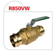
Válvula de esfera no cromada, conexiones de compresión con junta tórica negra según la norma EN681-1 para instalaciones de distribución de agua (potable y de calefacción), palanca verde. Paso integral.
