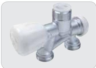
Válvula micrométrica termostatizable recta para instalaciones bitubo, entrada en el radiador por la parte inferior, sin enlace.
