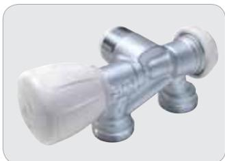
Válvula micrométrica termostatizable escuadra para instalaciones bitubo, entrada en el radiador por la parte inferior, conexión por la izquierda, sin enlace.
