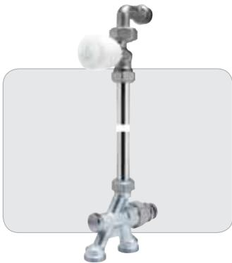
Grupo termostaticable para instalaciones bitubo con válvula recta y detentor, paso del 100% al radiador, enlace con autojunta.
