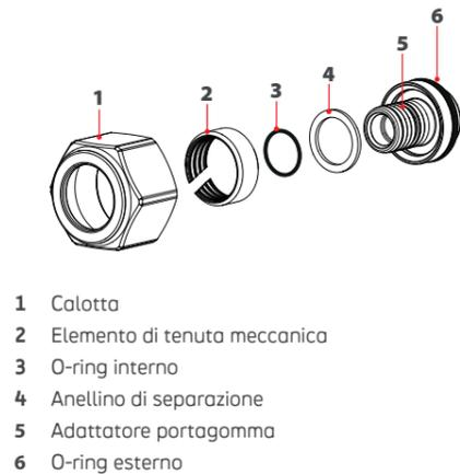
fig. 4.4 Caratteristiche costruttive
